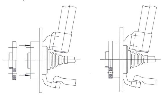
Die Distanzscheibe ist zunaechst lose auf den Radanschlussflansch des Fahrzeugs aufzustecken. Dabei muss sie plan anliegen.
