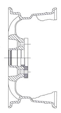
Anschliessend ist die Distanzscheibe auf die Innenseite des Rades aufzustecken. Auch hier muss die Scheibe vollstaendig anliegen. Erst nach dieser Kontrolle bitte mit der Montage beginnen.
